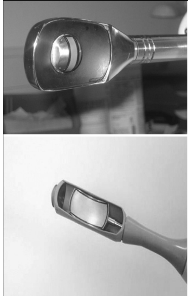
Şekil 10. HIFU sistemlerinde kullanılan probalar (75).
