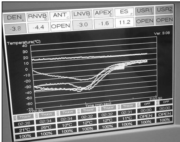
Şekil 6. Kriyoterapi esnasında prostat apeksine, dış sfinktere, denonvillier fasyasına, prostatın ortasına ve her iki nörovasküler bandla yerleştirilmiş ısı ölçerlerle dondurma ve eritme sikluslarının takibi
